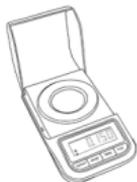
Wiege nun vorsichtig 150 mg (0,150 g) Deines homogenisierten Materials auf einer Milligramm-Waage ab. Für konzentrierte Extrakte verwendest Du eine proportional geringere Menge (so dass die Ergebnisse in den Bereich der Farbkarte passen). Wiege z.B. 75 mg Material für einen 2-fachen Extrakt ab. Wiege 15 mg Material für einen 10fachen Extrakt ab. (Du musst dann am Ende mit demselben Faktor multiplizieren. Dies wird später auch noch einmal erklärt.)
